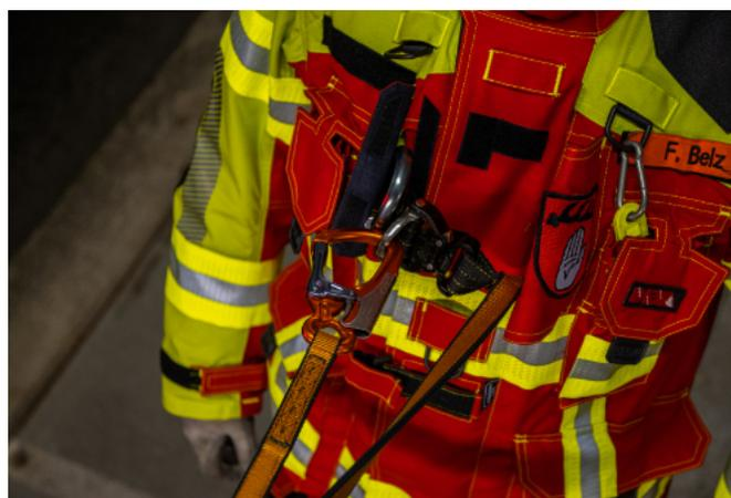
Kurzicherung mit dem IRS-System
